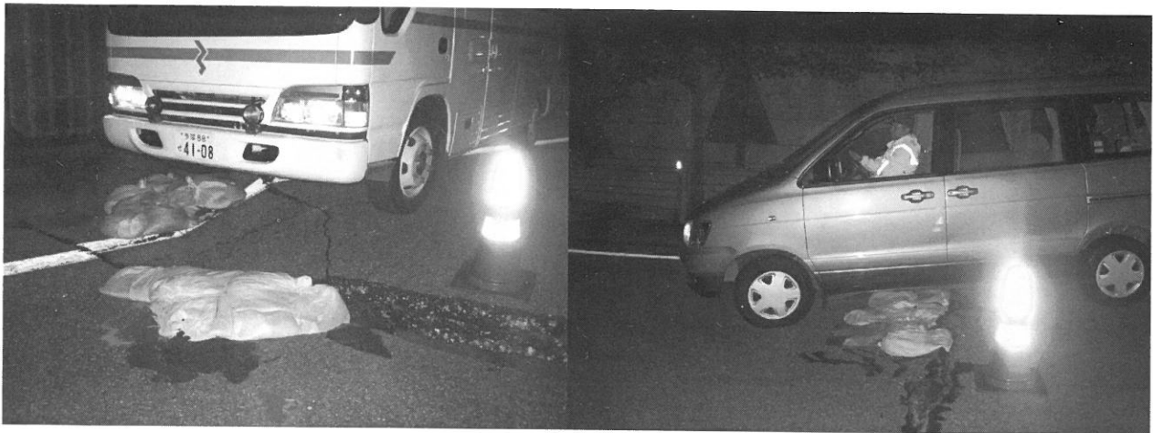
図 3 関越道の段差の通過
