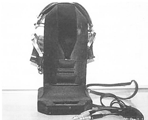
図17 バイノーラル録音のためのダミーヘッド 左右のレシーバーの中にマイクも備え付けてある。録音も再生もこのレシーバーで行う（ビクター社製）
